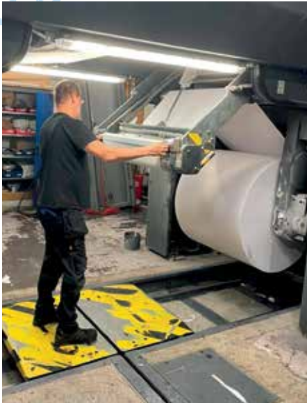
Paperi rullalta. Niinipuu painetaan rotaatiopainossa, jossa paperi tulee rullalta painotelojen väliin kulkevana katkeamattomana ratana. Paperirata leikataan sivuarkeiksi vasta painotyön loppuvaiheessa.
