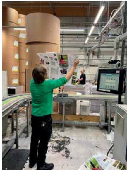
Kohdistukset kuntoon. Painaja tarkistaa painamisen alkuvaiheessa, että värit ovat kohdistuneet oikein painoarkilla.
